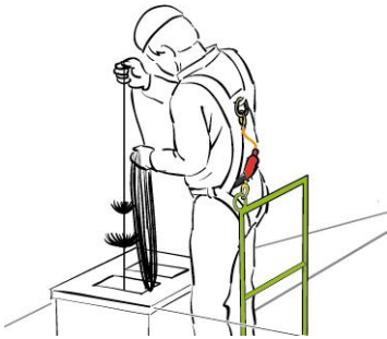
Figur 65. Förankring i skyddsräcke på arbetsplattform/gångbrygga.
